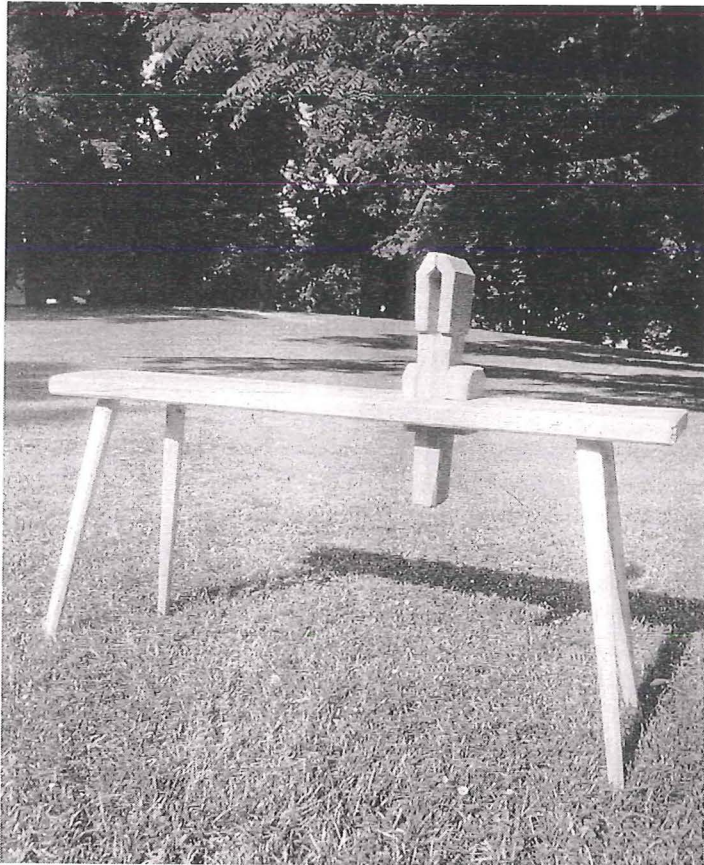
Abb. 10: Rekonstruktionsvorschlag: Einfache Kluppe zum Einspannen der Werkstücke. (Foto: Andreas RAUSCH).
